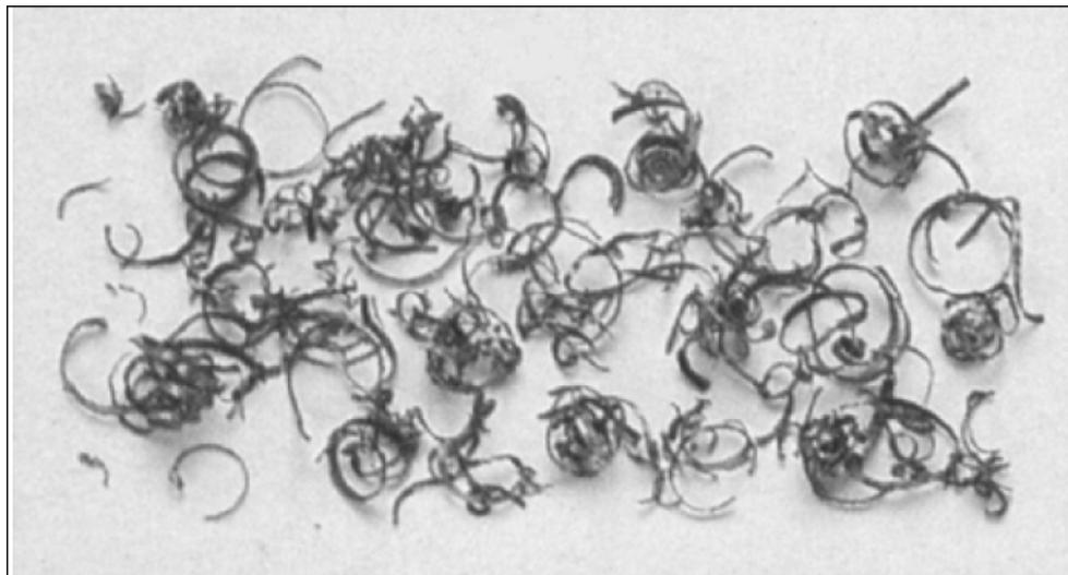
2. Толстая стружка синего цвета, указывает на то, что ленточная пила чрезмерно перегружена большой подачей.
