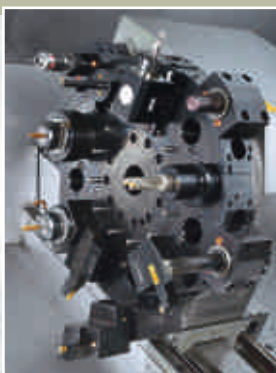
Револьверная головка VDI50 для TC800-MC
