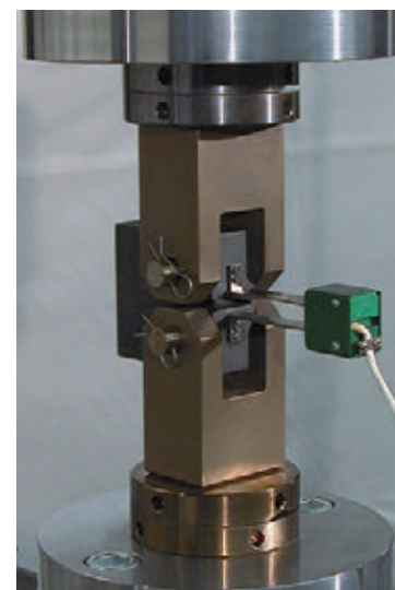
Карабинные захваты для испытаний компактных (СТ) образцов при растяжении
