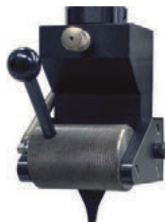
Эксцентриковые захваты для резиновых образцов до 5 кН
