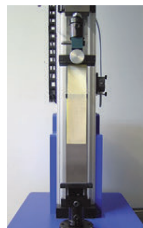
Устройство на отслаивание под углом 180°
