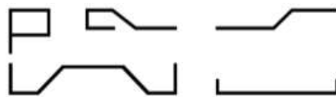
Рис. 5 Формы изгиба арматуры
