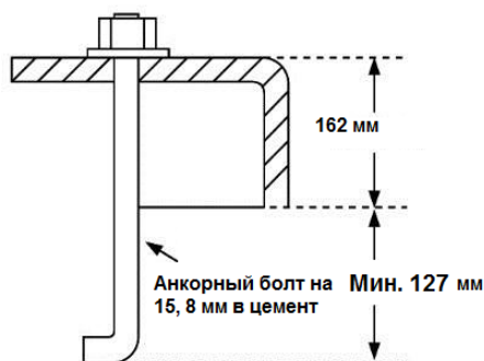
Схема крепления основания анкерными болтами
