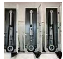
Индивидуальная настройка независимых абразивных станций
