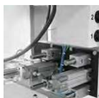
Пневматическое натяжение ленты
