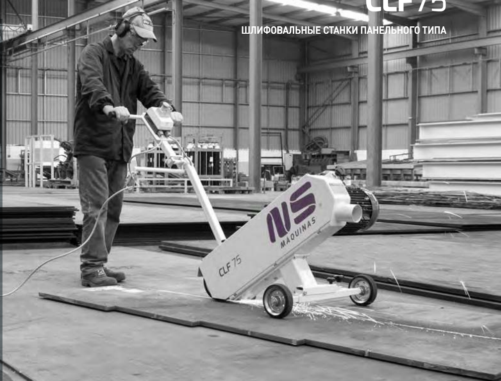
Удаление заусенцев и чистка сварных швов на толстых листах металла
