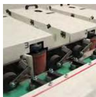
Боковые шлифовальные станции с вертикальными колебаниями для равномерного износа абразивной ленты
